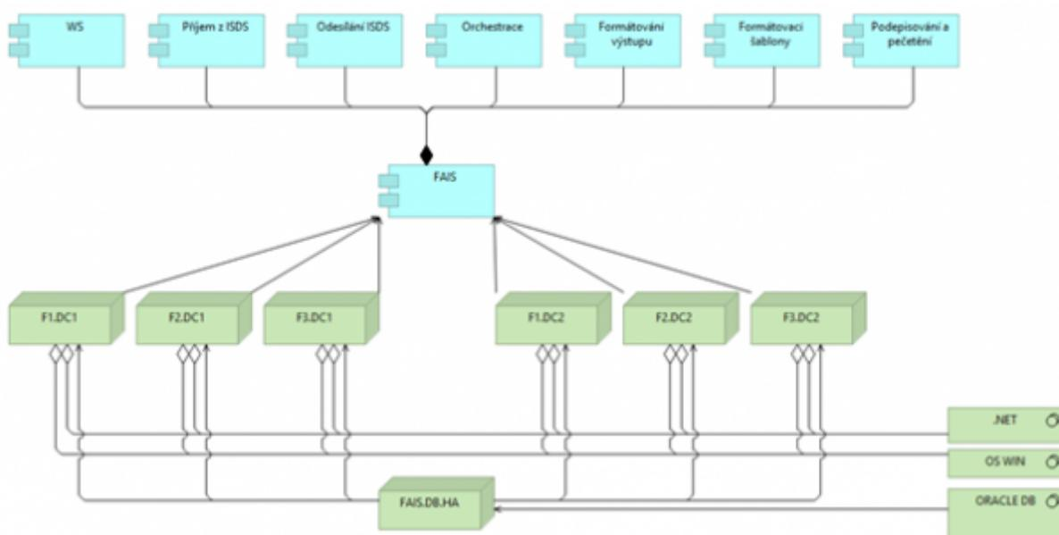
Na logických uzlech FAIS (Fx.DCx – virtuální server v datovém centru DC1 a DC2, tj. STC nebo CP) je spuštěn řídící proces. Na všech serverech jsou nainstalovány všechny interní aplikační komponenty FAIS (viz předchozí kapitola – aplikační role). Konfiguračně je řízeno, jaká konkrétní aplikační komponenta (nebo více komponent, respektive aplikačních rolí) je na konkrétním serveru spuštěna.
